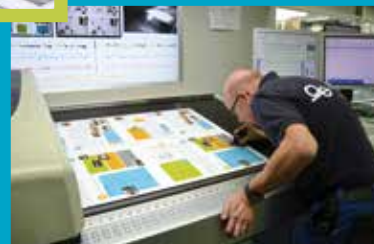
A droite, un technicien vérifie la qualité de la couleur à l'aide d'un compte-fils
